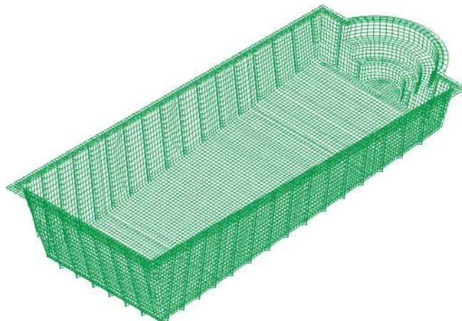
Mallado de nodos para análisis de Resistencia de Materiales por Elementos finitos
